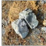
掘削時点では硬質土だが、水分を含むことにより粘質土に変化
