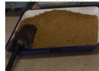
○土質試験を行ったところ、応力解放・降雨浸透により、砂岩が細粒化し、橋台背面盛土材として不適であると判明。
