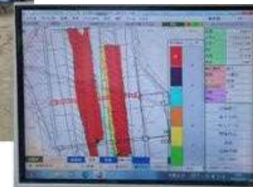
【転圧箇所の管理状況】
