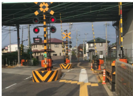
(踏切手前への視覚障害者誘導用ブロック、踏切内への誘導表示を設置した事例)
