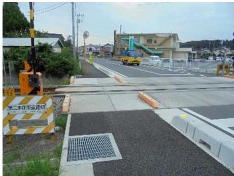
写真 2-7-31 ブロック等により分離している例
