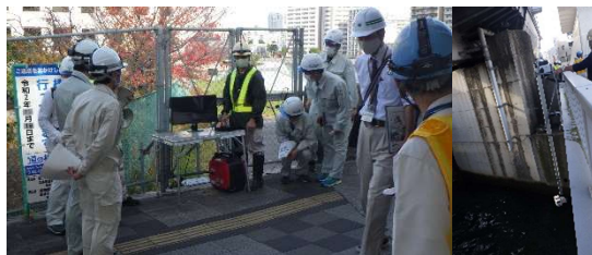
橋梁点検ロボットカメラ
