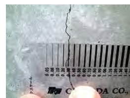
手作業による覆工ひび割れ幅の計測
