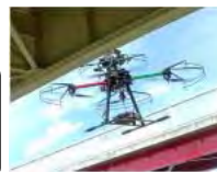
ドローンによる損傷把握
