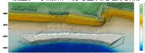
図 ALB(航空レーザ測深)とナローマルチビームによる三次元地形計測の事例(0.5mメッシュ)
