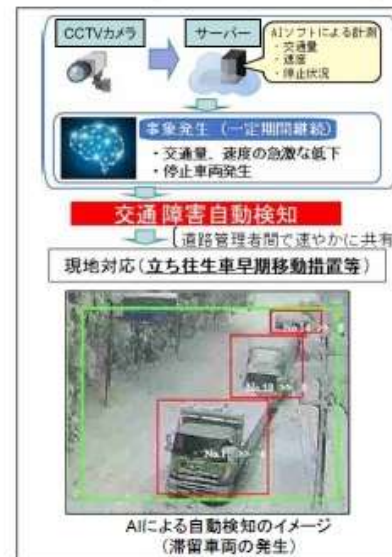
交通障害自動検知システム
