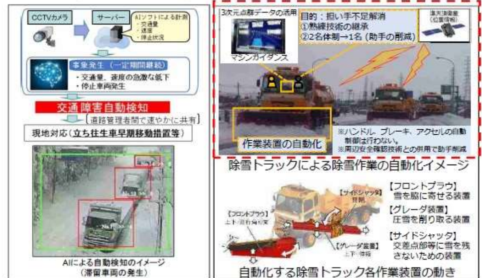
交通障害自動検知システム
