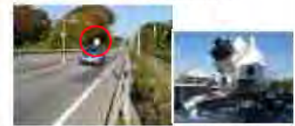
車載装置による路面性状測定
