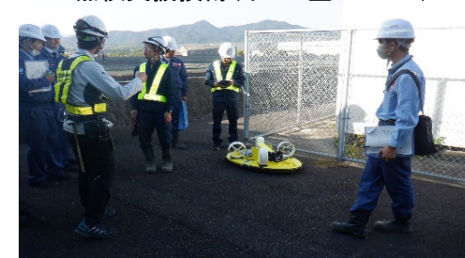
非破壊調査(RCレーダー)
