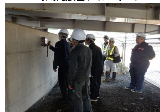
非破壊調査(RCレーダー)
