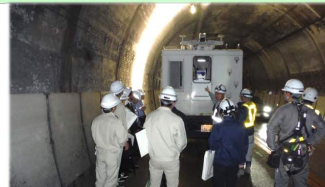
走行型高速3Dトンネル点検システム
