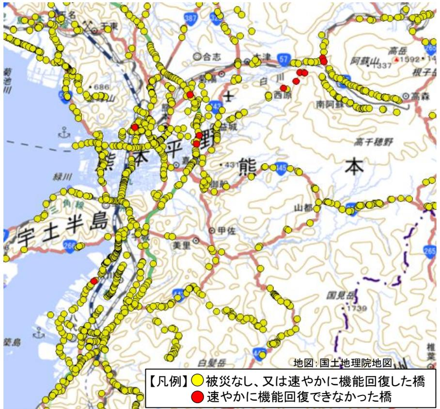
図-1 緊急輸送道路の橋の耐震性能の発揮状況
