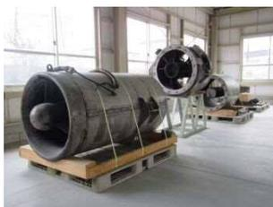
○ダム放流設備（口径1,200mm、ホロージェットバルブ&開閉機）
