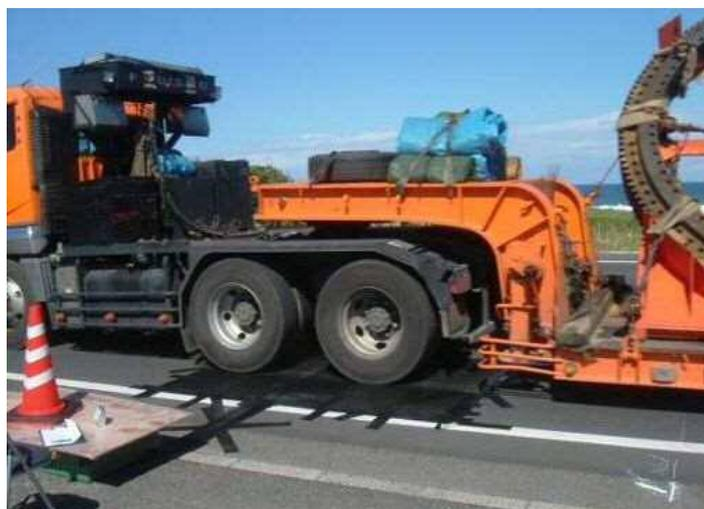
重量マットを用いた車両重量調査
