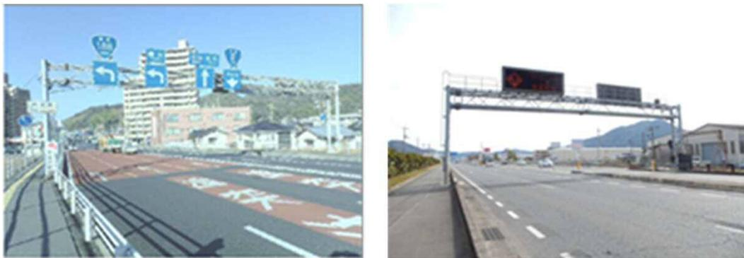
門型標識等とは、門型支柱(オーバーヘッド式)を有する大型の道路標識や情報提供装置(収集装置含む)をいう。
