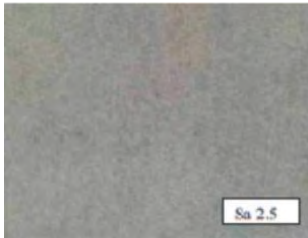
写真－Ⅱ． 7. 9 素地調整程度1 種 (素地調整 : Sa 2 1/2)
