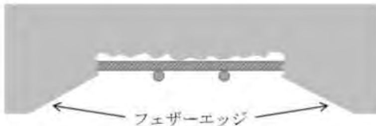
(1) フェザーエッジの例 (断面修復材が薄くなり、ひび割れ生じやすい)
