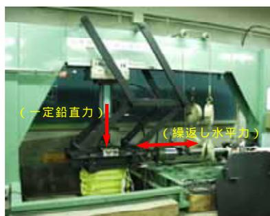
写真-2 実物「土のう」積層体の繰返しせん断試験機
