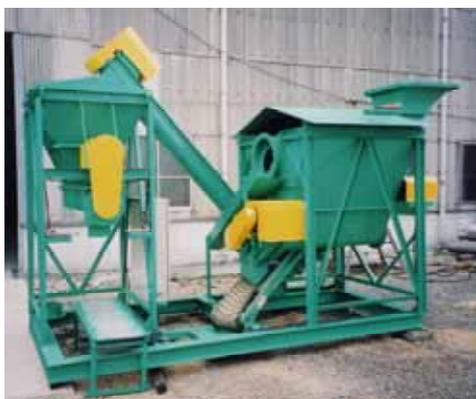
写真-1 「土のう」製造機の全景
