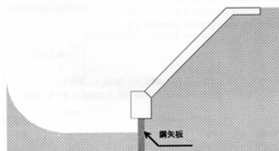
図-2 鋼矢板による洗掘対策
