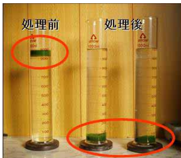
写真-3 沈降確認
