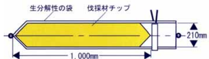
図-1 エコ法枠の構造
