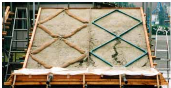
図-1 エコ法枠の構造
