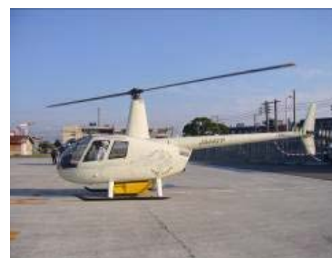
写真-1 底部に機器を搭載した小型有人ヘリコプタ
