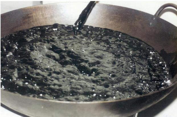
写真-2 中温化剤によるムース状のアスファルト発泡
