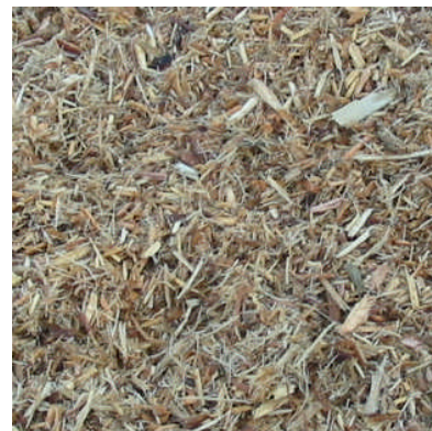
写真-3 タブグラインダによるウッドチップ（建設廃木材）
