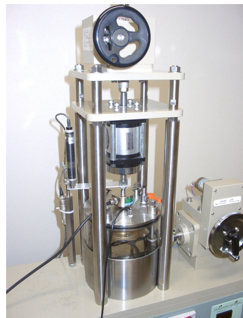
図4. サクシオン測定が可能な一面せん断試験装置
