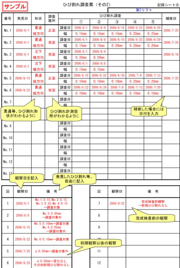
図-9-4 コンクリート打設管理記録 (ひび割れ調査票 2)
