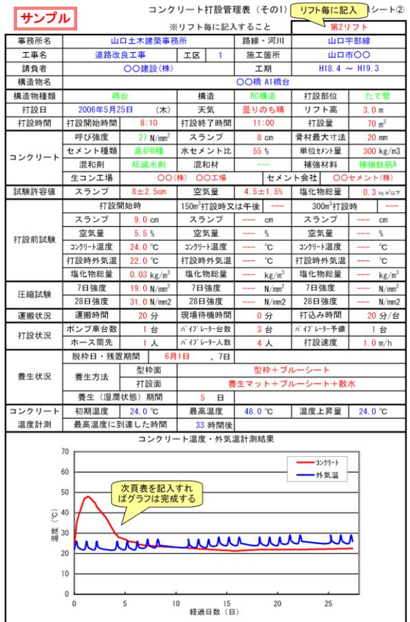
図-9-2 コンクリート打設管理記録(コンクリート打設管理表)
