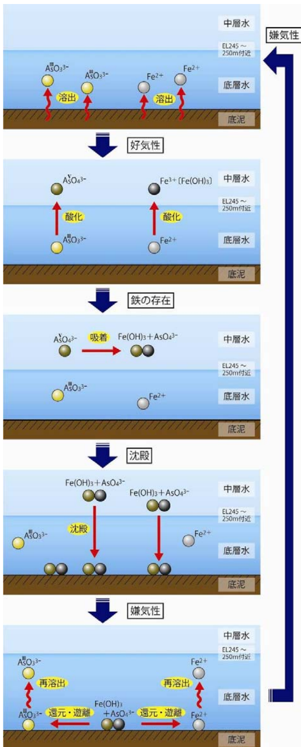
図-4 底層の嫌気化による重金属類溶出・循環のメカニズム
