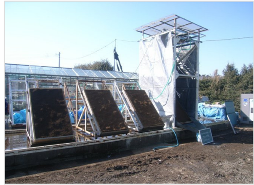
写真-2 人口降雨実験状況
