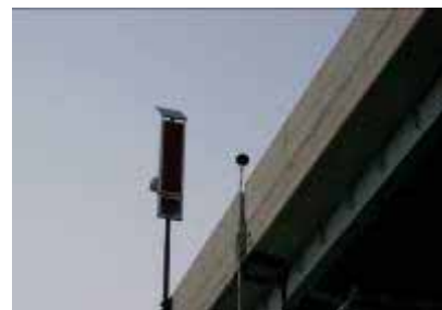
写真-1 騒音測定状況（壁高欄上）
