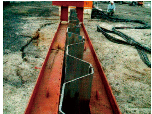
図-9 ハット形鋼矢板
