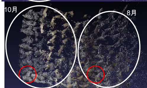
図-4 keyscale を用いた3次元復元結果のスケール調整の例 (異なる時期の撮影画像でも同スケールのブロックが復元できるように自動で調整)
