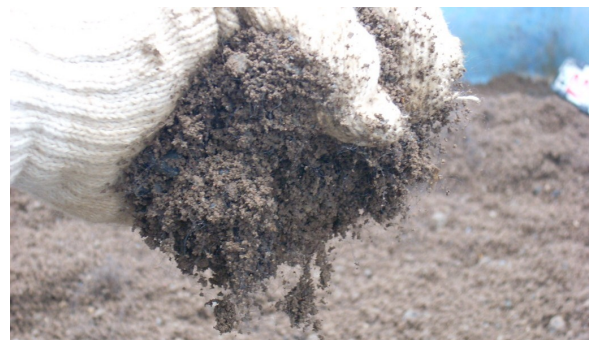
写真-2 破碎混合2回の短繊維混合補強土
