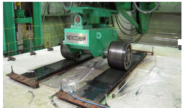
写真-2 輪荷重走行試験状況（高速道路総合技術研究所）
