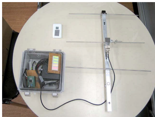
図-6 タグ電波計測装置試作機
