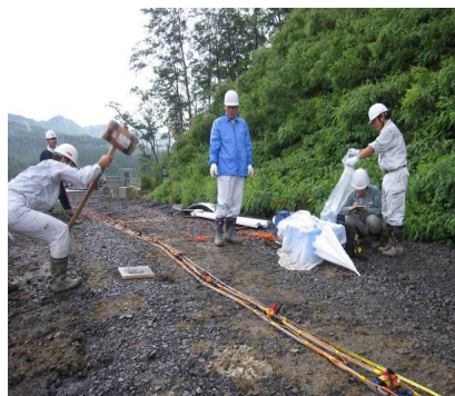
写真 - 9 計測状況 (カケヤによる起振)
