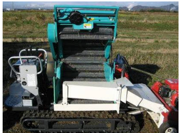
写真-6 チェーンバー間にネット設置
