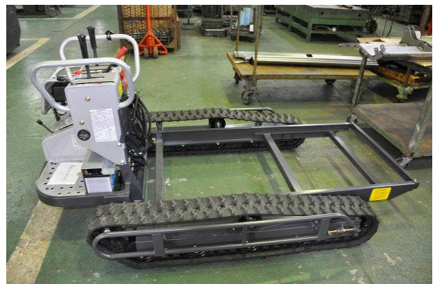
写真-8 大型履帯式走行装置
