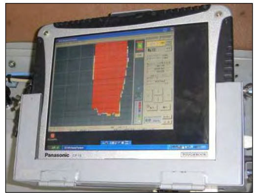
写真-6 締固め回数管理システム 車載モニター
