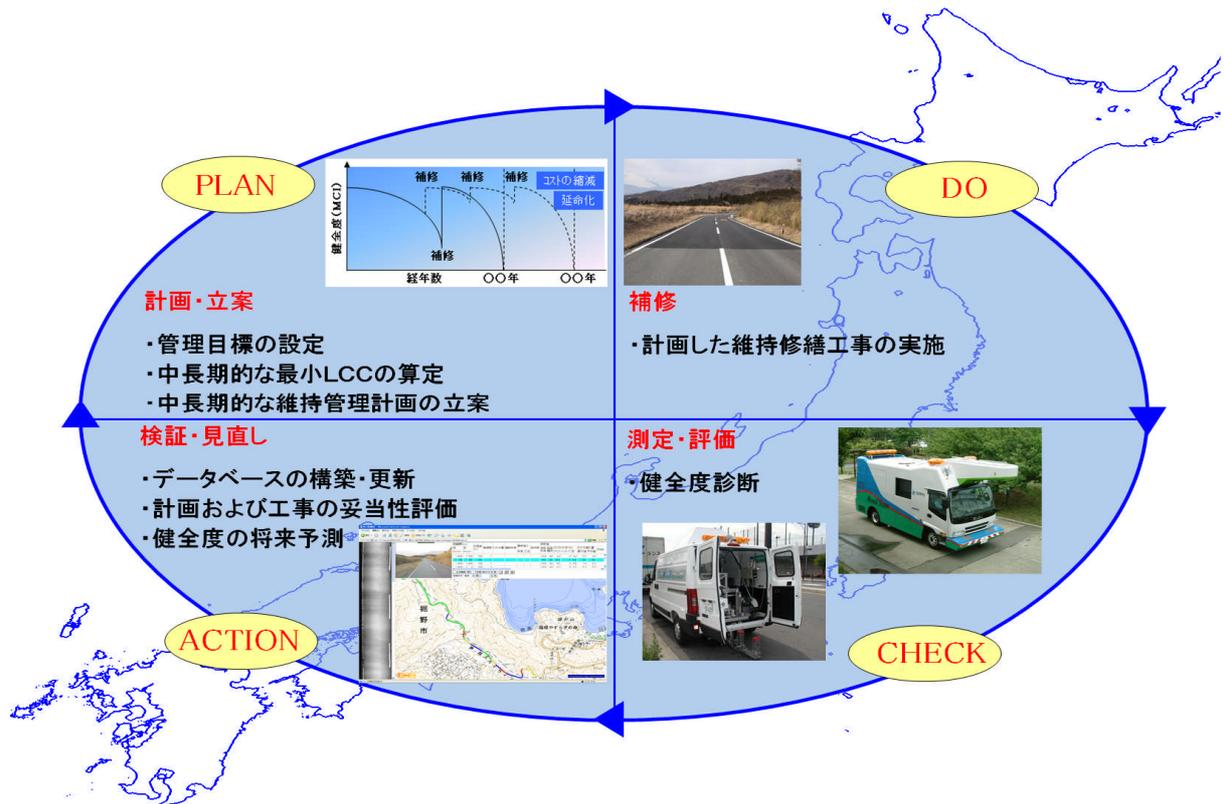
図-2 「道路舗装のアセットマネジメント構築支援技術」による管理の概念図
