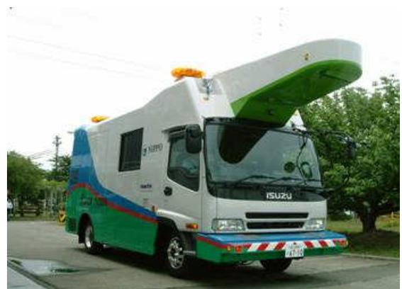
写真-1 路面性状測定車の外観
