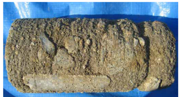
写真-1 7日強度試験に使用したコア供試体（松ヶ谷川）
