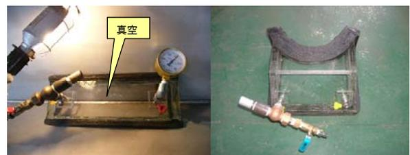
写真-4 溶接部発泡漏れ試験状況及び試験器具
