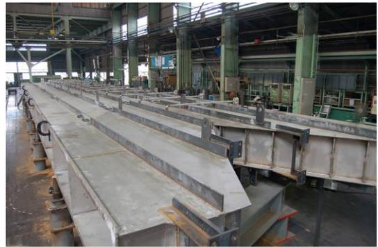
写真-3 選択取水管工場仮組立状況
