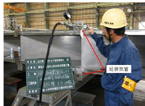
写真-5 給排気管気密試験状況
