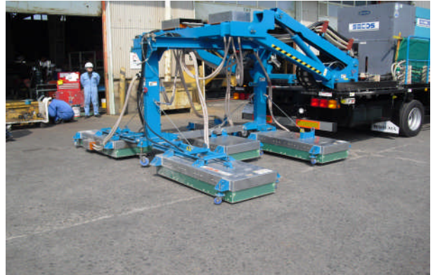
写真-3 I H式加熱機（2号機、後方加熱パネル側）
