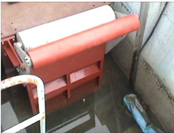
写真-3 ネオフラップ II 型 作動確認装置
