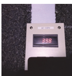
施工後の反射輝度測定 (398mcd/m 2 ・lx)
