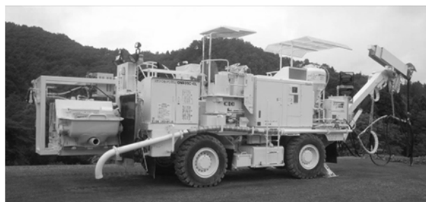
写真-1 一体型の吹付け設備
