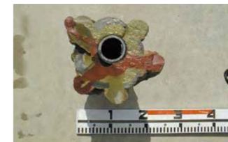
繰り返し注入により拡径されたアンカー体
