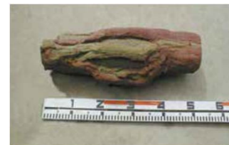
繰り返し注入により拡径されたアンカー体
