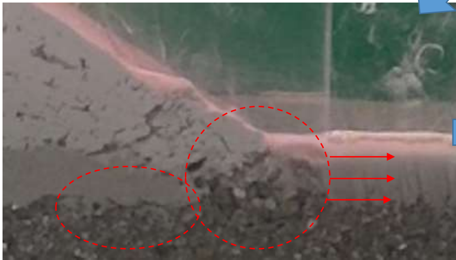
・ 810s, 水みち発生, 対策工の移動
