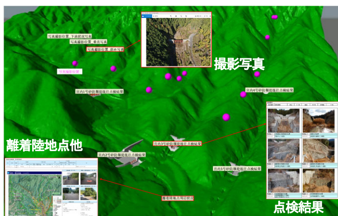
図-10 CIM 統合モデルを用いた UAV 点検データの利活用方法
