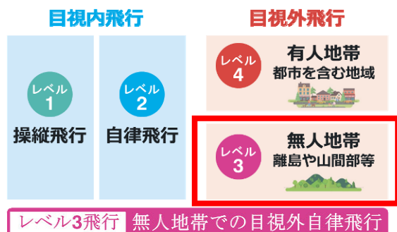
図- 13 UAV のレベル飛行形態
