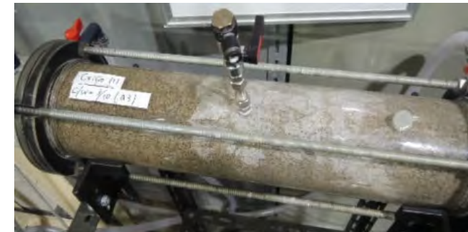
クレー注入状況
