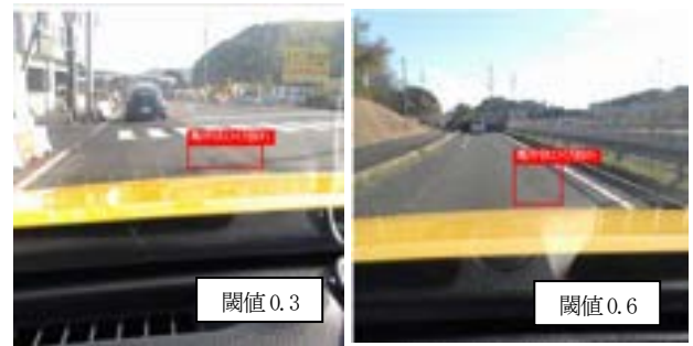
図-7 閾値による損傷取得事例（ひび割れ）
