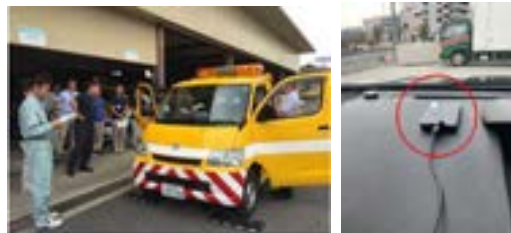
図 3-5 パトロール車に搭載した路面振動センサー
